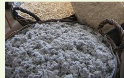
La ouate de cellulose, un isolant hygroscopique écologique
